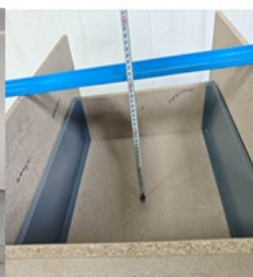
抽屉底板变形量的测定
