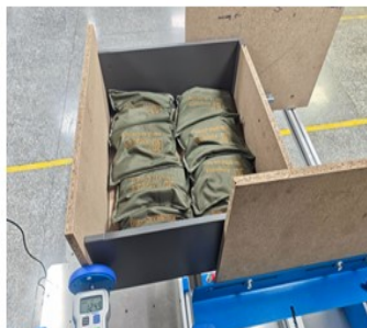
水平侧向过载试验
