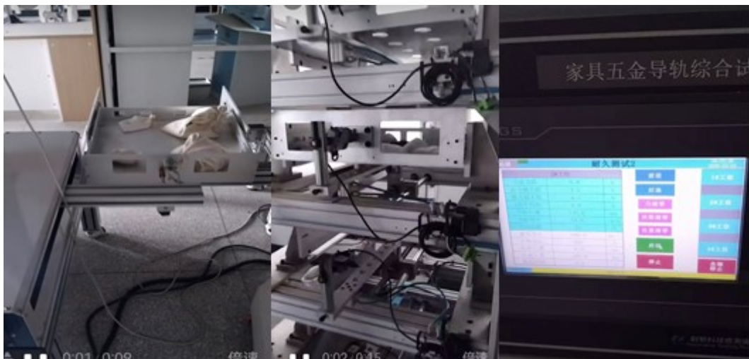
推拉构件综合试验机（多个导轨同时试验，节省试验场地）
