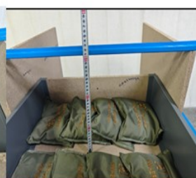
抽屉底板变形量的测定
