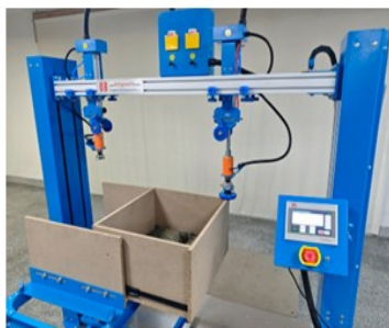
垂直向下过载试验
